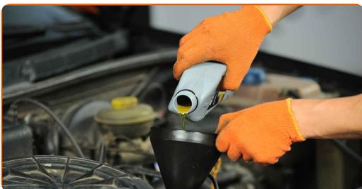
Sostituzione: olio motore e filtro - AUDI 60 Variant. Gli esperti di AUTODOC raccomandano:
