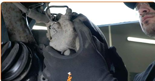
**14** Rimuovi i bulloni di fissaggio. Utilizza una chiave a bussola N°27.
