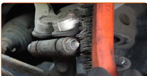
**17** Svitare gli elementi di fissaggio del braccio superiore. Utilizza una chiave a bussola N°16. Usa una chiave HEX N.H8. Usa una chiave a cricchetto.
