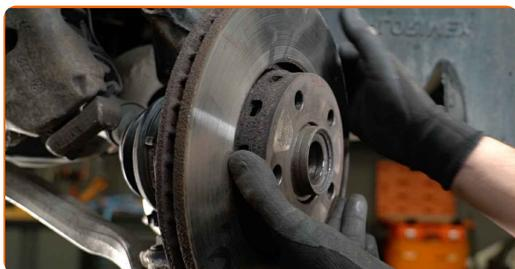
**16** Pulisci tutti gli snodi del braccio. Pulisci l'elemento di fissaggio che collega le testine tiranti al fuso a snodo. Usa una spazzola metallica. Usa lo spray WD-40.
