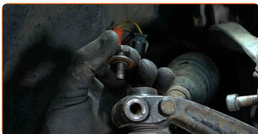
**22** Aprire gli occhielli per il bullone di serraggio della testina tirante sterzo. Usa uno scalpello piatto per la lavorazione dei metalli. Usa un martello.
