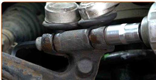
**18** Allentare il bullone di fissaggio della testina sterzo. Utilizza una chiave a bussola N°16. Usa una chiave a cricchetto.
