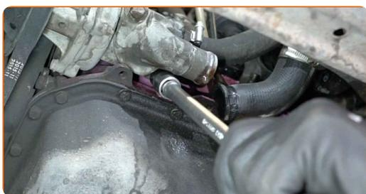
**9** Rimuovere l'alloggiamento del termostato.
