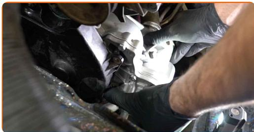
**26** Stringere i dispositivi di fissaggio della pompa dell'acqua. Utilizza una chiave combinata N°13. Utilizza una chiave a bussola N°13. Usa una chiave dinamometrica. Serralo fino allo coppia di torsione di 14 Nm.
