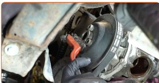
**12** Pulire l'elemento di fissaggio della puleggia della pompa dell'acqua. Usa una chiave HEX N.H6. Usa una chiave a cricchetto.
