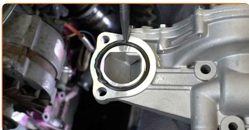
**25** Installare la nuova pompa dell'acqua.
