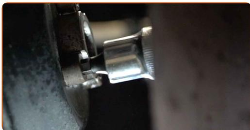
**13** Pulire gli elementi di fissaggio dell'alternatore. Usa una spazzola metallica. Usa lo spray WD-40.
