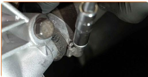
**29** Installare la puleggia della pompa dell'acqua.
