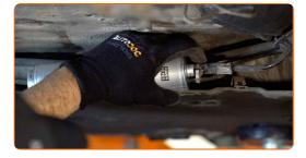
Serrare l'elemento di fissaggio della linea di alimentazione carburante. Usa un giravite piatto.
