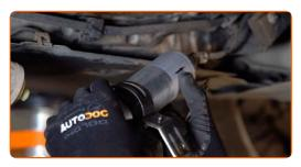
Serra l'elemento di fissaggio della staffa del filtro carburante. Usa la chiave Torx T20. Usa una chiave a cricchetto.
