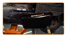
23 Installare il pannello di protezione.
