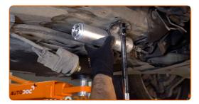
Collega il regolatore di pressione del carburante al filtro carburante. Installa l'anello elastico del clip di ritenuta del regolatore di pressione del carburante.
