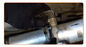
Stringere gli elementi di fissaggio del filtro carburante. Utilizza una chiave a bussola N°13. Usa una chiave a cricchetto.
