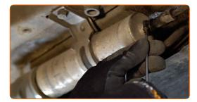
Rimuovi l'anello elastico della clip di ritenuta del regolatore di pressione del carburante.
