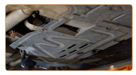
Stringere i bulloni di fissaggio del pannello di protezione. Utilizza una chiave a bussola N°8. Usa una chiave a cricchetto.
