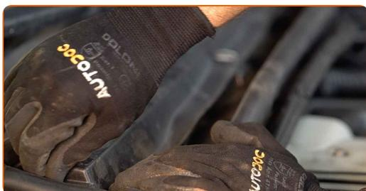
**33** Rimuovi la copertura di protezione del parafrango.
