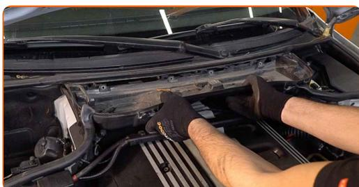
**10** Allentare il fissaggio del condotto di ammissione dell'aria. Usa una chiave HEX N.H5. Usa una chiave a cricchetto.
