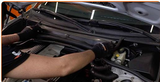
**32** Avvita gli elementi di fissaggio del coperchio del filtro abitacolo.
