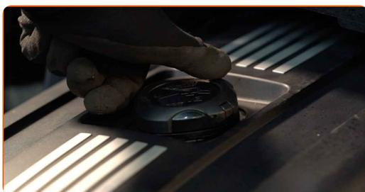
**4** Svitare il tappo dell'alloggiamento del filtro insieme al vecchio elemento filtrante. Usa la bussola 86-16F. Usa una chiave a cricchetto.
