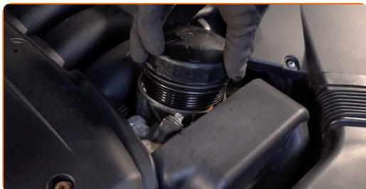
**28** Installare una nuova calotta carter filtro olio e serrarla. Usa la bussola 86-16F. Usa una chiave dinamometrica. Serralo fino allo coppia di torsione di 25 Nm.
