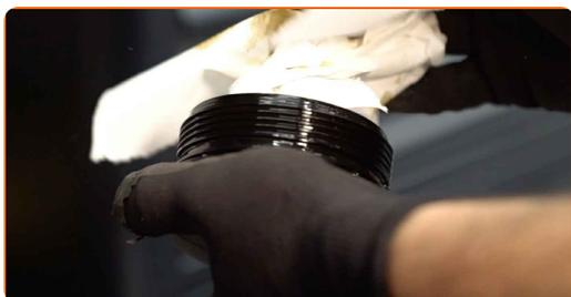
**24** Installa i nuovi o-ring e il nuovo filtro dell'olio alle loro sedi di montaggio sul coperchio del filtro.
