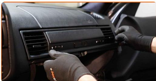
**24** Avvitare le viti di fissaggio del vano portaoggetti. Usa un cacciavite Phillips.
