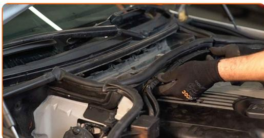
**15** Inserire un nuovo elemento filtrante nell'alloggiamento del filtro. Assicurarsi che i bordi del filtro aderiscano all'alloggiamento.
