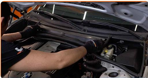
**17** Avvita gli elementi di fissaggio del coperchio del filtro abitacolo.
