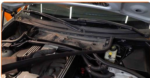
**7** Svitare i bulloni di fissaggio della carcassa del filtro. Usa la chiave Torx T 20. Usa una chiave a cricchetto.
