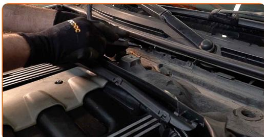
**8** Scollega il cablaggio dall'alloggiamento del filtro abitacolo.
