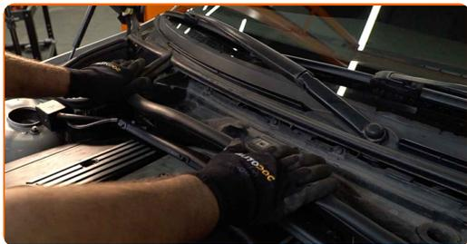
**14** Collega il cablaggio all'alloggiamento del filtro abitacolo.
