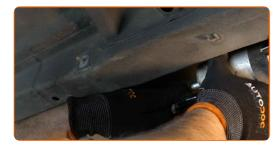
Pulire la staffa di montaggio del filtro carburante. Usa lo spray WD-40.
