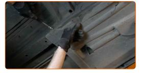
Installare le clip del pannello di copertura del sottoscocca.
