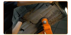
Avvitare gli elementi di fissaggio del pannello di copertura del sottoscocca. Utilizza una chiave a bussola N°8. Utilizza una chiave a bussola N°10. Usa una chiave a cricchetto.
