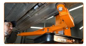
Rimettere a posto il pannello di copertura del sottoscocca.
