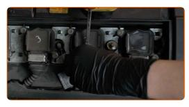
Scollega gli elementi di fissaggio della bobina di accensione. Utilizza una chiave a bussola N°10. Usa una chiave a cricchetto.
