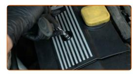
Installa l'alloggiamento del condotto dell'aria.
