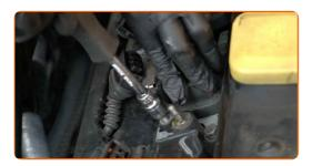
Serrare i dispositivi di fissaggio della bobina di accensione. Utilizza una chiave a bussola N°10. Usa una chiave dinamometrica. Serralo fino allo coppia di torsione di 11 Nm.
