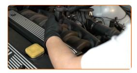
Rimuovere la copertura del motore.
