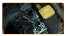
Avvitare le nuove candele e serrarle. Usa la chiave a bussola per candele numero 16. Usa una chiave dinamometrica. Serralo fino allo coppia di torsione di 26 Nm.
