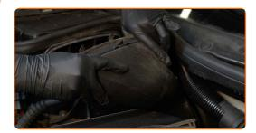
Svita gli elementi di fissaggio del coperchio del motore. Utilizza una chiave a bussola N°10. Usa una chiave a cricchetto.
