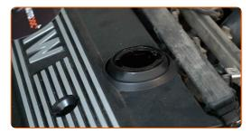
Rimuovere la copertura del motore.
