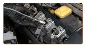
Applica uno strato sottile dello speciale lubrificante antigrippaggio per alte temperature alle filettature delle candele nuove.
