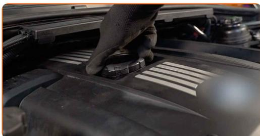
**33** Far funzionare il motore per qualche minuto. Dopo che la spia di segnalazione luminosa della pressione dell'olio sarà spenta, spegni il motore.
