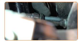
Rimuovere il mozzo integralmente con il cuscinetto, in quanto essi costituiscono un blocco non smontabile. Usa un piede di porco. Usa un martello.
