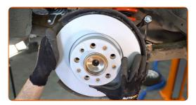
Serrare l'attacco del disco freno. Usa una chiave HEX N.H5. Usa una chiave dinamometrica. Serralo fino allo coppia di torsione di 7 Nm.
