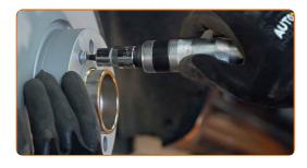
Installare il sostegno pinza freno.
