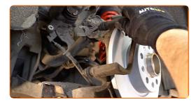
Serrare il sostegno pinza freno. Utilizza una chiave a bussola N°E12. Usa una chiave dinamometrica. Serralo fino allo coppia di torsione di 60 Nm.
