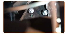
Serrare l'attacco del mozzo. Utilizza una chiave a bussola N°E14. Usa una chiave dinamometrica. Serralo fino allo coppia di torsione di 77 Nm.
