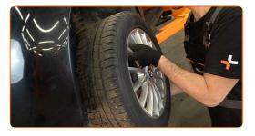
Pulisci gli elementi di fissaggio della pinza freno. Usa una spazzola metallica. Usa un pulitore freni.
