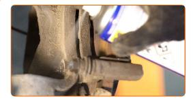
Svitare l'attacco della staffa pinza freno. Utilizza una chiave a bussola N°E12. Usa una chiave a cricchetto.
