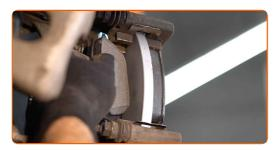
Montare la pinza del freno e fissarla. Utilizza una chiave combinata N°13. Utilizza una chiave combinata N°15. Utilizza una chiave a bussola N°13. Usa una chiave dinamometrica. Serralo fino allo coppia di torsione di 35 Nm.
