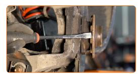
Pulisci la sede di montaggio del cuscinetto del mozzo. Usa una spazzola metallica. Usa un detergente spray multiuso.
