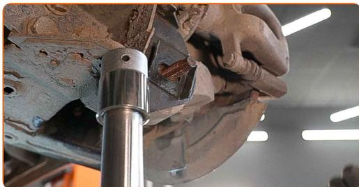
**68** Avvita l'elemento di fissaggio posteriore che collega lo snodo posteriore al braccio di controllo. Utilizza una chiave combinata N°22.
