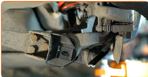
**66** Puntellare il braccio. Usa un cric idraulico per trasmissione.
