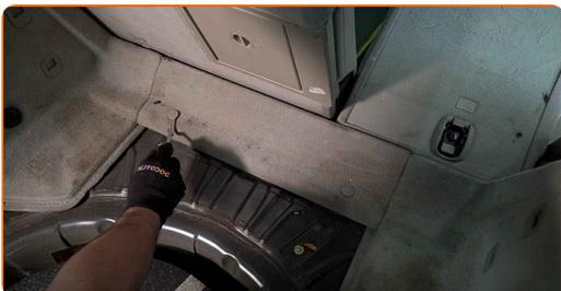
**8** Rimuovi la parte anteriore del rivestimento inferiore del cofano.
