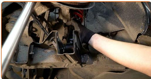
**61** Avvita l'elemento di fissaggio superiore del montante supporto ammortizzazione. Non lo serrare.
