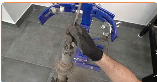
Sostituzione: ammortizzatore a molla - ALFA ROMEO SPIDER (939). Consiglio:
