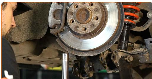
Sostituzione: ammortizzatore a molla - ALFA ROMEO SPIDER (939). Il consiglio di AUTODOC:
