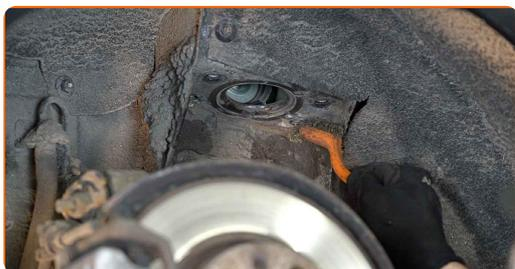
**60** Installare il supporto di ammortizzazione nell'arco passaruota.
