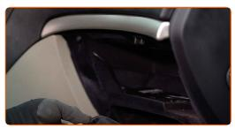
Allenta la vite del rivestimento interno della scatola a guanti e rimuovi il rivestimento. Usa un giravite piatto. Usa un cacciavite Phillips.
