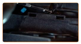
Installa il rivestimento della scatola a guanti e avvita gli elementi di fissaggio della stessa. Usa un cacciavite Phillips.
