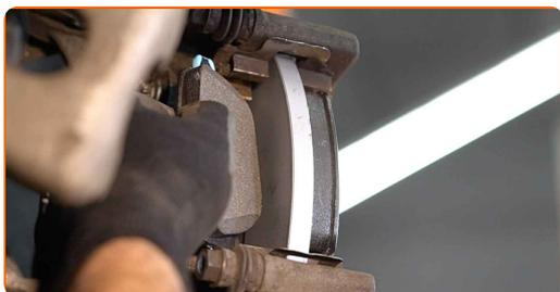
**28** Montare la pinza del freno e fissarla. Utilizza una chiave combinata N°13. Utilizza una chiave combinata N°15. Usa una chiave dinamometrica. Serralo fino allo coppia di torsione di 35 Nm.
