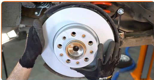
**19** Serrare l'attacco del disco freno. Usa una chiave HEX N.H5. Usa una chiave dinamometrica. Serralo fino alla coppia di torsione di 7 Nm.
