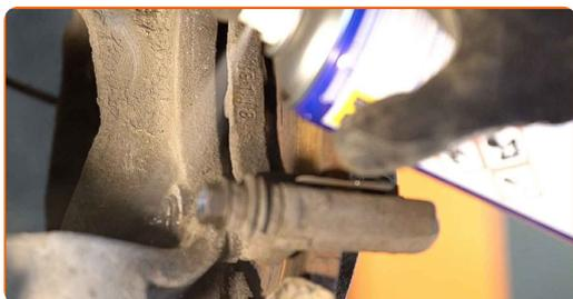
**12** Svitare l'attacco della staffa pinza freno. Utilizza una chiave a bussola N°E12. Usa un giramaschi.
