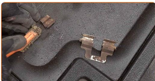
**21** Pulire il sostegno pinza freno da sporco e polvere. Usa una spazzola metallica. Usa un detergente spray multiuso.
