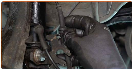
**46** Fissare sul montante il tubo dell'impianto freni.
