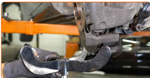
**15** Pulisci gli elementi di fissaggio del braccio di controllo. Usa una spazzola metallica. Usa lo spray WD-40.
