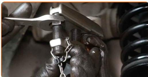
**18** Rimuovi gli elementi di fissaggio collegati al tubo flessibile del freno all'ammortizzatore. Usa un piede di porco.
