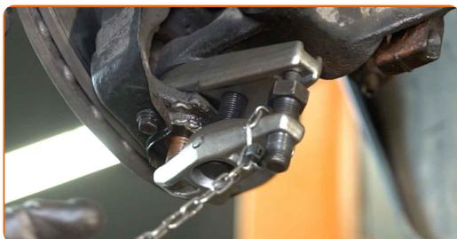
**14** Puntellare il fuso a snodo. Usa un cric idraulico per trasmissione.
