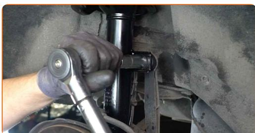
**67** Fissare sul montante il tubo dell'impianto freni.
