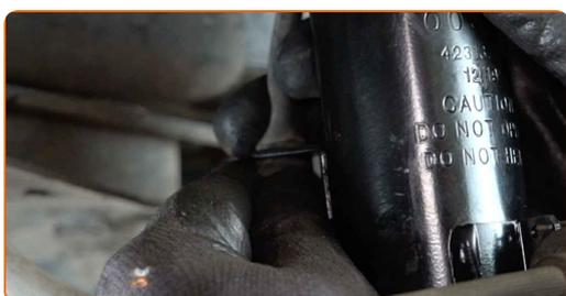
**70** Tratta con del prodotto gli elementi di fissaggio del puntone dell'ammortizzatore. Tratta con del prodotto tutti i giunti della barra stabilizzatrice. Tratta con del prodotto gli elementi di fissaggio posteriori dello snodo. Usa il grasso al rame.
