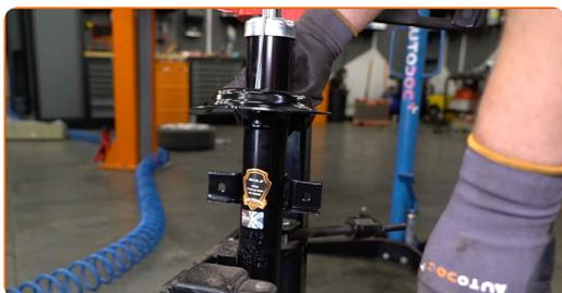
**45** Installare il parapolvere e il limitatore flessione dinamica sul nuovo ammortizzatore.
