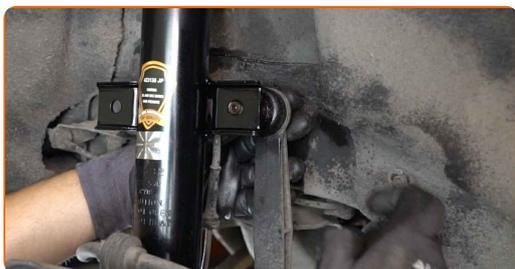
**65** Serra gli elementi di fissaggio del tirante della barra stabilizzatrice. Utilizza una chiave combinata N°17. Usa una chiave HEX N.H5. Usa una chiave a cricchetto.
