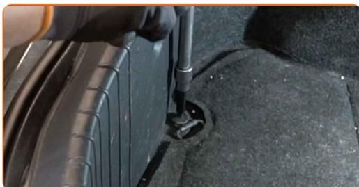
**7** Rimuovi la copertura centrale di protezione in plastica.
