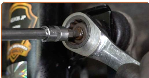
**66** Serra gli elementi di fissaggio che collegano il tirante della barra stabilizzatrice al puntone dell'ammortizzatore. Utilizza una chiave a bussola N°17. Usa una chiave dinamometrica. Serralo fino allo coppia di torsione di 55 Nm.
