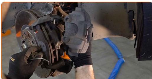
Sostituzione: dischi freni - ALFA ROMEO GIULIETTA (940). AUTODOC raccomanda:
