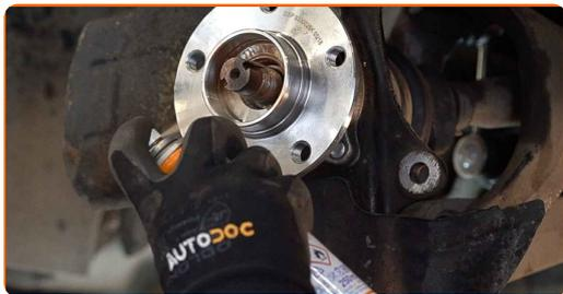
**43** Avvitare il dado di fissaggio del mozzo della ruota.
