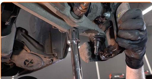
**37** Collega il giunto sferico al fuso a snodo. Collegare il braccio inferiore al fuso a snodo.
