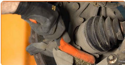
**15** Svitare l'attacco della staffa pinza freno. Utilizza una chiave a bussola N°19. Usa un giramaschi. Usa una chiave a cricchetto.
