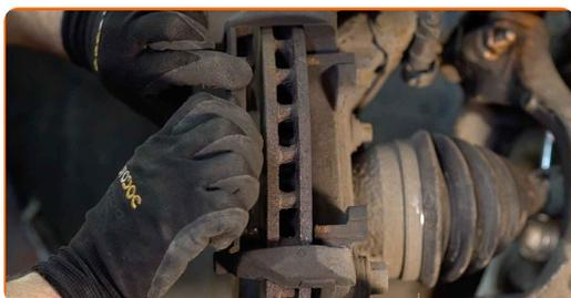
**14** Pulisci gli elementi di fissaggio del supporto pinza freno. Usa una spazzola metallica. Usa lo spray WD-40.
