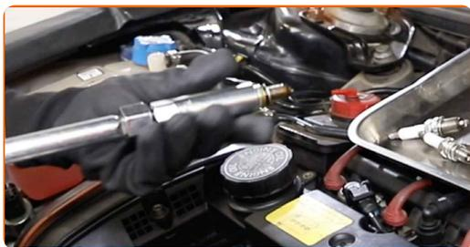
**15** Applica uno strato sottile dello speciale lubrificante antigrippaggio per alte temperature alle filettature delle candele nuove.
