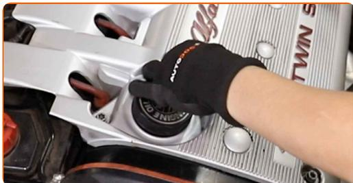
**27** Avvita gli elementi di fissaggio del coperchio del motore. Usa la chiave Torx T40. Usa una chiave a cricchetto.
