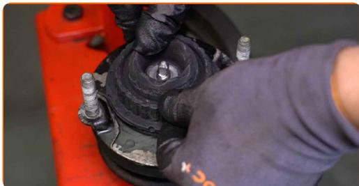
**41** Serrare la vite dell'asta pistone supporto ammortizzazione. Usa la chiave a bussola per ammortizzatore DDN<sup>®</sup>6. Utilizza una chiave a bussola N°16. Usa una chiave dinamometrica. Serralo fino allo coppia di torsione di 35 Nm.
