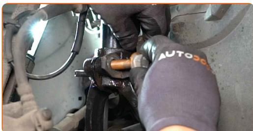
**50** Pulisci le sedi di montaggio e la filettatura del braccio di sospensione. Usa una spazzola metallica. Usa lo spray WD-40.
