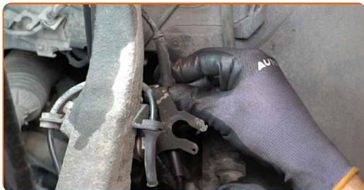
**57** Fissare sul montante il tubo dell'impianto freni.
