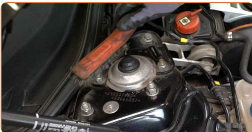
**4** Svita gli elementi di fissaggio superiori del puntone dell'ammortizzatore. Utilizza una chiave a bussola N°17. Usa una chiave a cricchetto.
