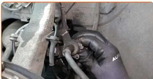
**58** Installa la clip di fissaggio del tubo flessibile del freno.
