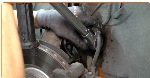
**60** Serrare l'elemento di fissaggio che collega il braccio di sospensione al fuso a snodo. Utilizza una chiave a bussola N°17. Usa una chiave dinamometrica. Serralo fino allo coppia di torsione di 50 Nm.
