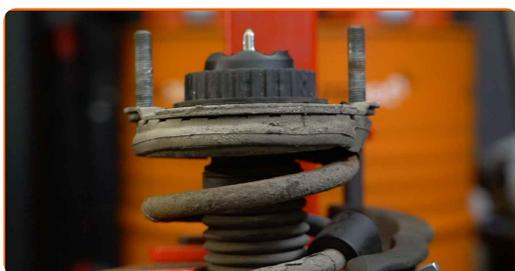
**30** Rimuovere il dado del montante del supporto di ammortizzazione. Usa la chiave a bussola per ammortizzatore DDN#6 Utilizza una chiave a bussola N°17. Usa una chiave a cricchetto.
