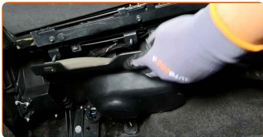
**12** Avvita gli elementi di fissaggio del pannello poggiatesta laterale del passeggero. Utilizza una chiave a bussola N°8. Usa una chiave a cricchetto.
