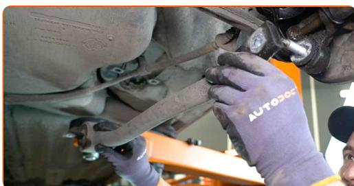
**12** Pulisci le sedi di montaggio e la filettatura del braccio di sospensione. Usa una spazzola metallica. Usa lo spray WD-40.
