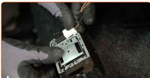
**75** Installare la luce interna del bagagliaio.
