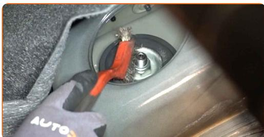
**17** Allenta gli elementi di fissaggio superiori del supporto dell'ammortizzatore. Usa una chiave HEX N.H6. Utilizza una chiave a bussola N°22. Usa una chiave a cricchetto.
