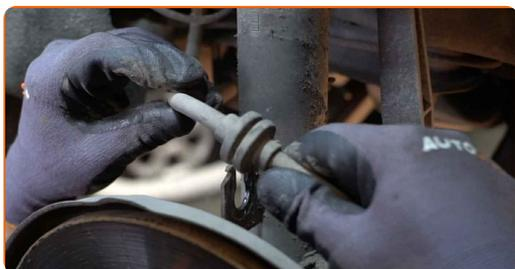
**24** Scollegare il cablaggio del sensore ABS.
