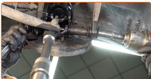
**51** Avvitare l'elemento di fissaggio che collega l'ammortizzatore al fuso a snodo posteriore. Utilizza una chiave combinata N°19. Utilizza una chiave a bussola N°19. Usa una chiave a cricchetto.
