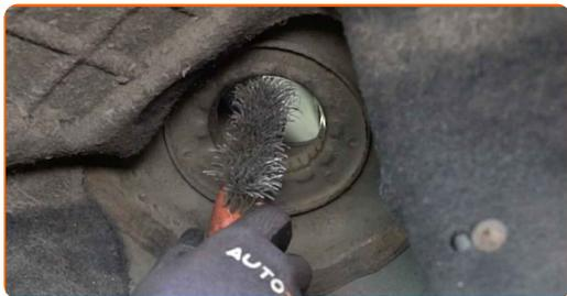
**46** Installare il supporto di ammortizzazione nell'arco passaruota.
