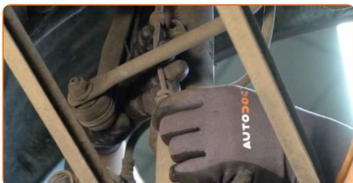
**25** Pulisci gli elementi di fissaggio dei tiranti delle barre stabilizzatrici. Usa una spazzola metallica. Usa lo spray WD-40.
