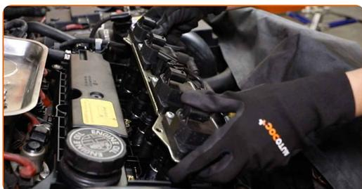
**19** Stringere gli elementi di fissaggio della bobina di accensione. Usa la chiave Torx T40. Usa una chiave dinamometrica. Serralo fino allo coppia di torsione di 7 Nm.
