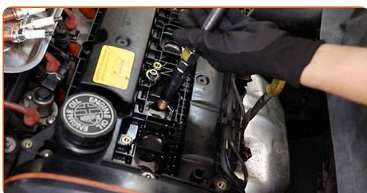
**17** Avvitare le nuove candele e serrarle. Usa la chiave a bussola per candele numero 16. Usa una chiave dinamometrica. Serralo fino allo coppia di torsione di 24 Nm.
