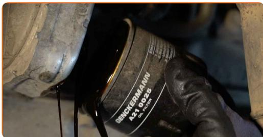
Sostituzione: olio motore e filtro - Alfa Romeo 147 937. Il consiglio di AUTODOC:
