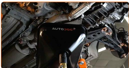
**6** Pulisci la zona del foro di drenaggio della coppa dell'olio. Usa una spazzola metallica. Usa un detergente spray multiuso.
