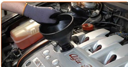
**22** Versa l'olio nel motore attraverso serbatoio. Quantità di olio richiesta:4 l.
