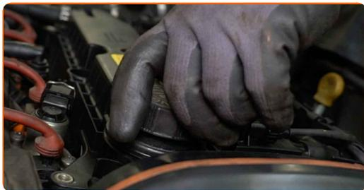
**18** Sul lato destro, stacca il tubo flessibile della valvola di ventilazione del carter dal coperchio del motore. Usa un giravite piatto.
