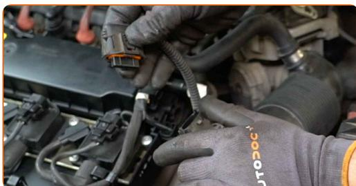
**21** Scollegare il cablaggio del sensore MAF (debimetro). Usa un giravite piatto.
