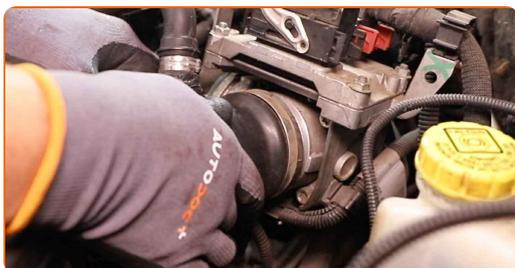
**55** Stringi il morsetto e gli elementi di fissaggio sul tubo di aspirazione del filtro dell'aria. Utilizza una chiave a bussola N°7. Usa una chiave a cricchetto.
