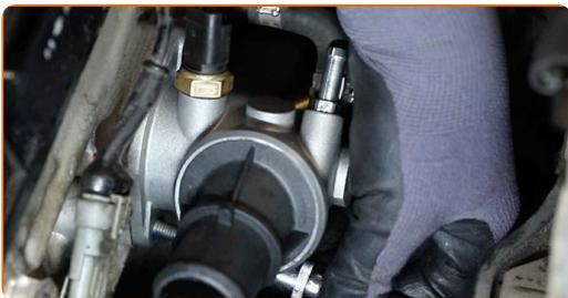
**41** Stringere gli elementi di fissaggio dell'alloggiamento del termostato. Utilizza una chiave a bussola N°13. Usa una chiave dinamometrica. Serralo fino allo coppia di torsione di 11 Nm.
