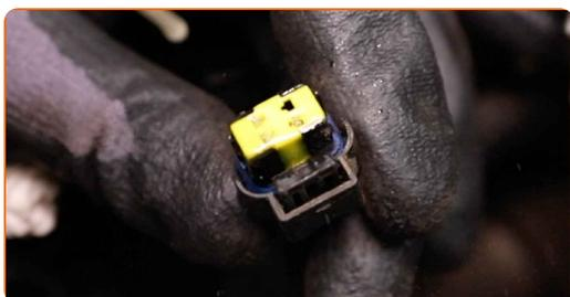
**51** Inserire il connettore del sensore di temperatura del fluido di raffreddamento.
