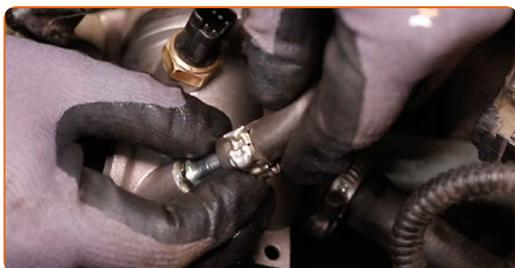
**45** Fissare il morsetto del tubo di raffreddamento. Usa le pinze per fascette Clic-R.
