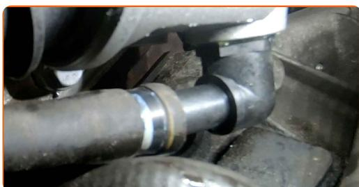
**47** Fissare il morsetto del tubo di raffreddamento. Usa le pinze per fascette Clic-R.
