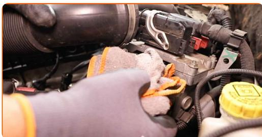
**54** Collega il tubo di aspirazione dell'aria all'alloggiamento del filtro dell'aria.
