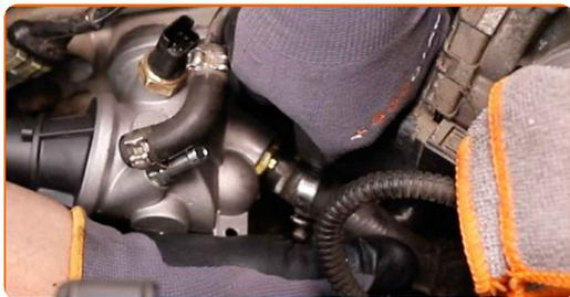
**43** Fissare il morsetto del tubo di raffreddamento. Utilizza una chiave a bussola N°7. Usa una chiave a cricchetto.
