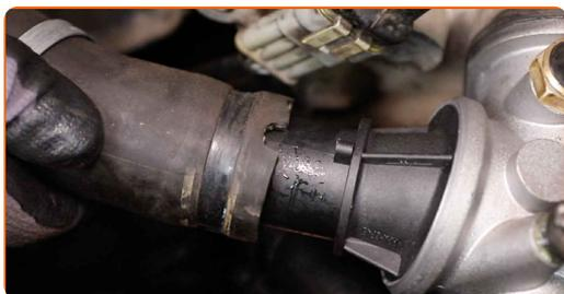
**49** Fissare il morsetto del tubo di raffreddamento. Utilizza una chiave a bussola N°7. Usa una chiave a cricchetto.
