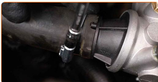
**50** Applicare un prodotto trattante sul connettore del sensore di temperatura del refrigerante. Usa il grasso al silicone.
