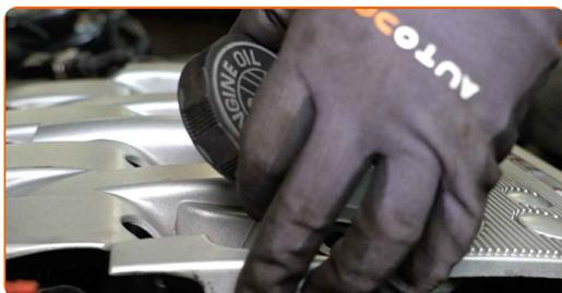
**15** Rimuovere la copertura del motore.
