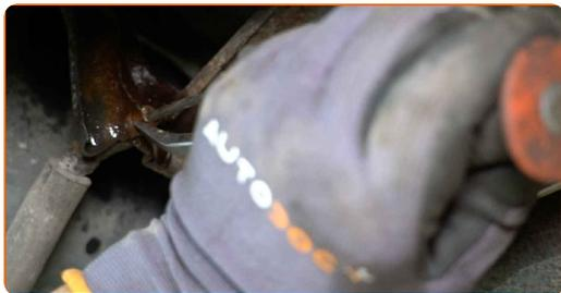
**14** Sgancia il cavo del freno di stazionamento.
