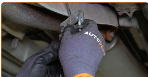
**18** Pulire le sedi di montaggio del cavo del freno di stazionamento. Usa una spazzola metallica. Usa lo spray WD-40.
