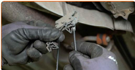
**15** Rimuovere il cavo del freno di stazionamento.
