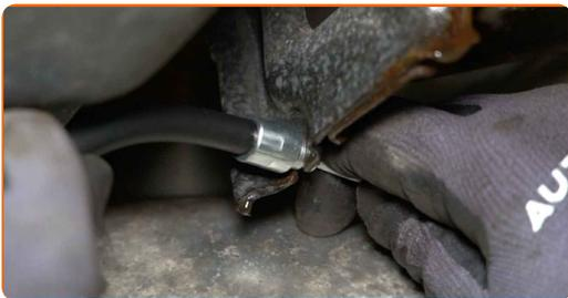
**20** Fissa il cavo del freno di stazionamento con il clip di fissaggio. Usa le pinze per pompa ad acqua.
