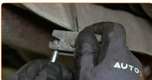
**17** Fissare il cavo del freno di stazionamento.
