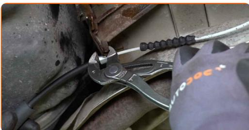
**21** Fissare il cavo del freno di stazionamento alla carrozzeria.
