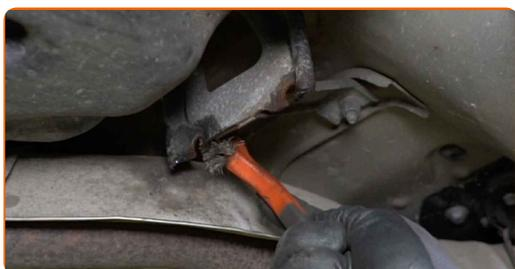
**19** Collega il cavo del freno di stazionamento al meccanismo del freno stesso.
