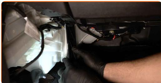
**10** Avvita gli elementi di fissaggio del coperchio del filtro abitacolo. Usa la chiave Torx T 25.
