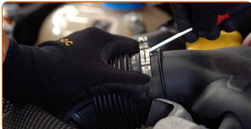
**4** Scollega il collare di fissaggio del tubo di ventilazione del carter motore. Usa un giravite piatto.
