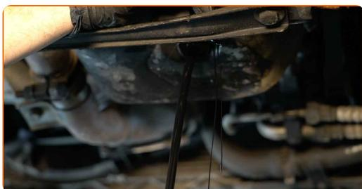
Sostituzione: olio motore e filtro - ABARTH 500C / 595C / 695C Cabrio (312).
