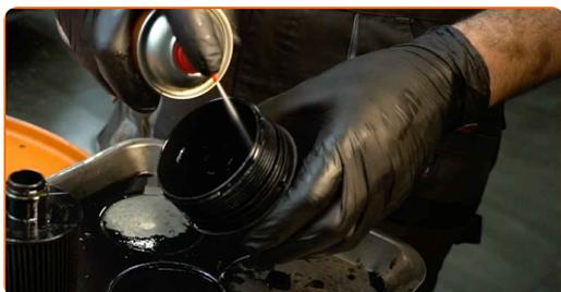
**18** Installa il nuovo coperchio O-ring sulla sua sede di montaggio sul coperchio del filtro.
