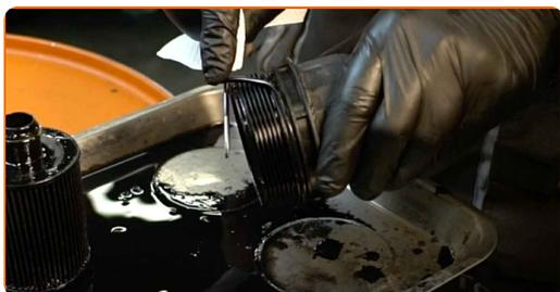
**17** Pulisci il tappo dell'alloggiamento del filtro dell'olio. Usa un detergente spray multiuso.
