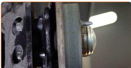
**14** Pulisci la superficie del disco freno. Usa una spazzola metallica. Usa lo spray WD-40.
