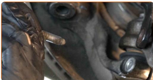
**16** Scollega l'elemento di fissaggio che collega il giunto sferico al fuso a snodo. Usa una chiave a bussola specifica per rimuovere l'ammortizzatore. Usa una chiave a cricchetto.
