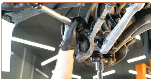
**34** Solleva il cric idraulico per trasmissione di 10-15 cm.
