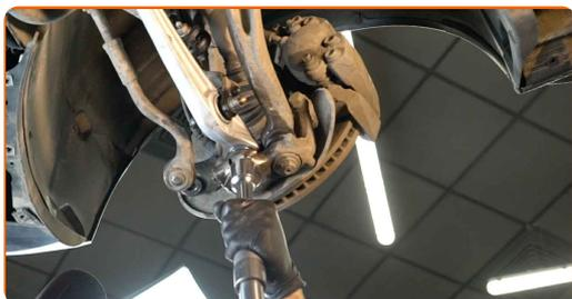
Sostituzione: braccio inferiore anteriore - Audi A4 B8. Gli esperti di AUTODOC raccomandano:
