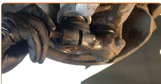
**31** Avvita gli elementi di fissaggio del giunto sferico. Utilizza una chiave a bussola N°16. Usa una chiave a cricchetto.
