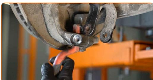
**24** Installare il nuovo braccio. Usa un martello di gomma. Usa una chiave a bussola specifica per rimuovere l'ammortizzatore. Usa una chiave a cricchetto.
