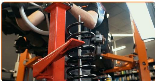
**31** Installare il parapolvere e il limitatore flessione dinamica sul nuovo ammortizzatore.
