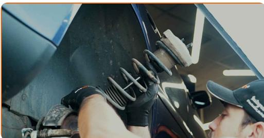
**18** Montare il supporto di ammortizzazione sul dispositivo speciale per la compressione delle molle.
