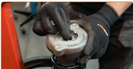
**33** Serrare la vite dell'asta pistone supporto ammortizzazione. Utilizza una chiave a bussola N°16. Usa la chiave a bussola per ammortizzatore DDN°5,2. Usa una chiave dinamometrica. Serralo fino allo coppia di torsione di 25 Nm.
