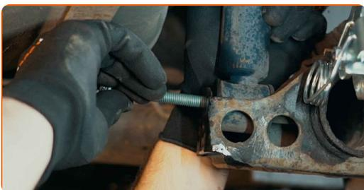
**16** Svita gli elementi di fissaggio superiori del puntone dell'ammortizzatore.
