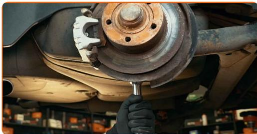
**44** Serrare il perno di fissaggio inferiore del supporto di ammortizzazione. Utilizza una chiave combinata N°16. Utilizza una chiave a bussola N°16. Usa una chiave dinamometrica. Serralo fino allo coppia di torsione di 50 Nm. +90°
