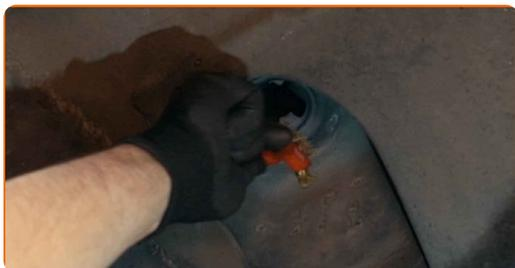
**39** Installare il supporto di ammortizzazione nell'arco passaruota. Usa un piede di porco.
