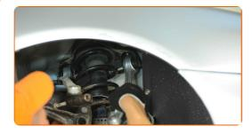
Stringere gli elementi di fissaggio del braccio di controllo superiore. Utilizza una chiave combinata N°16 (2 pezzi). Usa una chiave dinamometrica. Serralo fino allo coppia di torsione di 50 Nm. +90°
