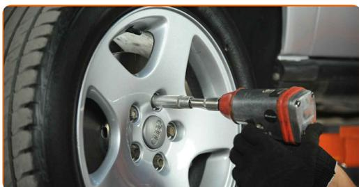
**33** Rimettere il veicolo per terra e, lavorando in ordine incrociato, serrare i bulloni di fissaggio delle ruote. Usa la chiave a bussola per dadi cerchio ruota n.17. Usa una chiave dinamometrica. Serralo fino allo coppia di torsione di 120 Nm.
