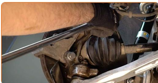
**17** Rimuovi i bulloni di fissaggio (2 pezzi).
