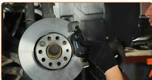
**27.1** Montare la pinza del freno e fissarla.
