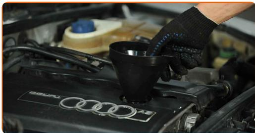
**20** Versa l'olio nel motore attraverso serbatoio. Quantità di olio richiesta:3.9 l.
