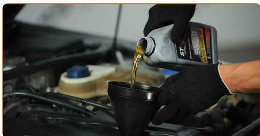
Sostituzione: olio motore e filtro - Audi A4 B5 Avant. Il consiglio di AUTODOC:
