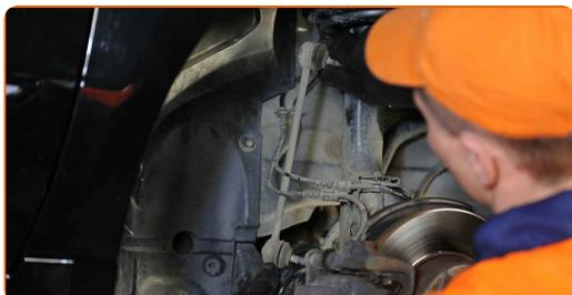
Sostituzione: biellette barra stabilizzatrice - Mercedes W169. Gli esperti di AUTODOC raccomandano:
