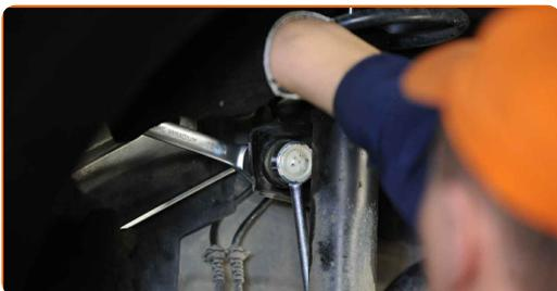
**13** Serra gli elementi di fissaggio che collegano il tirante della barra stabilizzatrice alla barra. Utilizza una chiave combinata N°16. Usa la chiave Torx T 30. Usa una chiave dinamometrica. Serralo fino allo coppia di torsione di 60 Nm.
