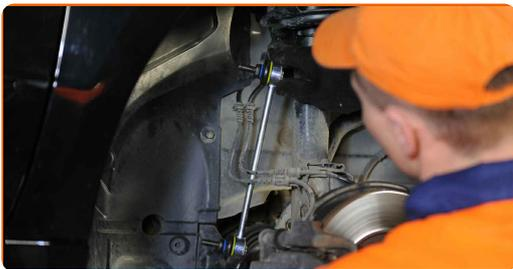
**12** Serra gli elementi di fissaggio che collegano il tirante della barra stabilizzatrice al puntone dell'ammortizzatore. Utilizza una chiave combinata N°16. Usa la chiave Torx T 30. Usa una chiave dinamometrica. Serralo fino allo coppia di torsione di 60 Nm.
