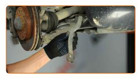
Pulisci le sedi di montaggio delle testine tiranti dello sterzo. Usa una spazzola metallica. Usa lo spray WD-40.
