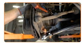
Svitare il dado di attacco del gambo al fuso a snodo. Utilizza una chiave a bussola N°18. Usa una chiave a cricchetto.
