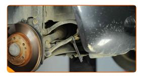
Pulisci l'elemento di fissaggio che collega le testine tiranti al fuso a snodo. Usa una spazzola metallica. Usa lo spray WD-40.
