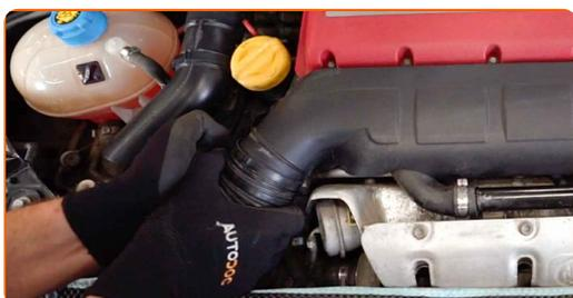
**33** Fissa il collare di fissaggio al tubo di aspirazione. Usa delle pinze universali.
