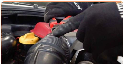
**34** Fissa il collare di fissaggio al tubo di ventilazione del carter motore. Usa delle pinze universali.
