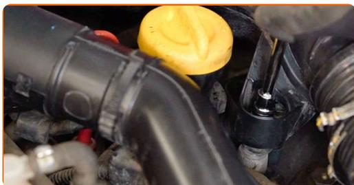
**32** Collega il tubo di aspirazione dell'aria all'alloggiamento del filtro dell'aria.
