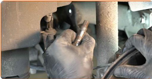
14 Pulisci le sedi di montaggio e la filettatura del braccio di sospensione. Usa una spazzola metallica. Usa lo spray WD-40.
