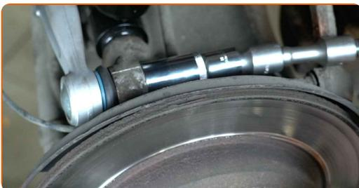
**19** Avvitare il dispositivo di fissaggio che collega il braccio di controllo al controtelaio. Utilizza una chiave combinata N°16.
