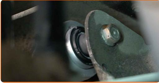
**17** Avvita l'elemento di fissaggio che collega il braccio di controllo allo snodo posteriore. Utilizza una chiave combinata N°22. Utilizza una chiave a bussola N°10. Usa una chiave a cricchetto.
