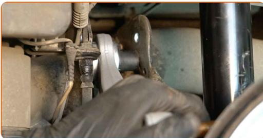
Sostituzione: braccio superiore posteriore - BMW E39. AUTODOC raccomanda:
