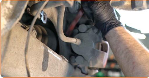
**27** Svitare l'attacco della staffa pinza freno. Utilizza una chiave a bussola N°16. Usa un giramaschi.
