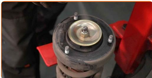
**45** Rimuovere il dado del montante del supporto di ammortizzazione. Usa la chiave a bussola per ammortizzatore DDN°6. Utilizza una chiave a bussola N°16. Usa una chiave a cricchetto.
