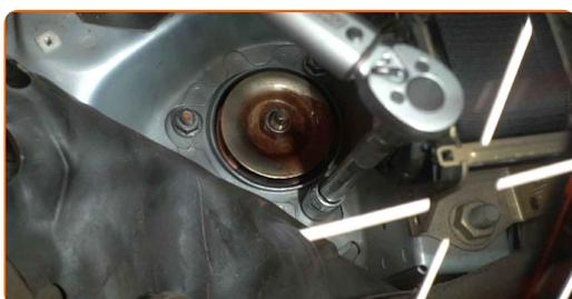
**87** Tratta con del prodotto gli elementi di fissaggio del supporto del puntone dell'ammortizzatore. Usa il grasso al rame.
