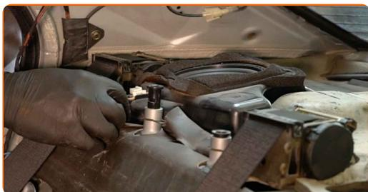
91 Avvitare gli elementi di fissaggio degli altoparlanti. Usa un cacciavite Phillips.
