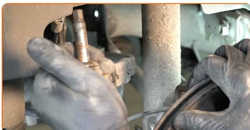
**40** Svita l'elemento di fissaggio superiore del montante supporto ammortizzazione.
