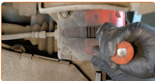
**26** Pulisci gli elementi di fissaggio del supporto pinza freno. Usa una spazzola metallica. Usa lo spray WD-40.
