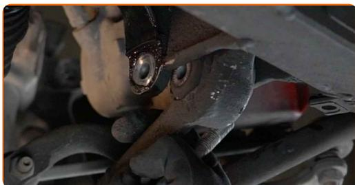
**34** Pulisci gli elementi di fissaggio che collegano il puntone dell'ammortizzatore al fuso a snodo. Usa una spazzola metallica. Usa lo spray WD-40.
