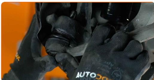
**67** Avvita il dado di serraggio che collega le testine tiranti dello sterzo al fuso a snodo. Utilizza una chiave combinata N°18.
