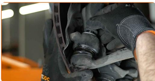
**68** Installa il supporto montante dell'ammortizzatore usando il buco centrale come guida.
