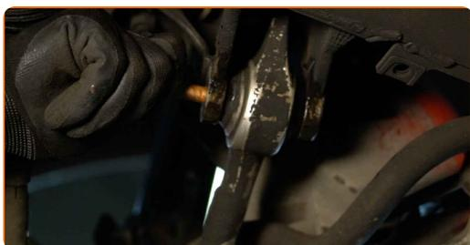
**63** Rimuovi il supporto da sotto il fuso a snodo.
