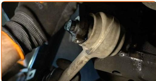
**61** Pulisci le sedi di montaggio e la filettatura del braccio di sospensione. Usa una spazzola metallica. Usa lo spray WD-40.
