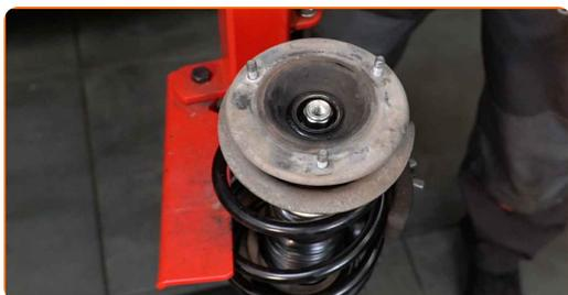
**51** Serrare la vite dell'asta pistone supporto ammortizzazione. Utilizza una chiave a bussola N°22. Usa una chiave HEX N.H6. Usa una chiave dinamometrica. Serralo fino allo coppia di torsione di 64 Nm.
