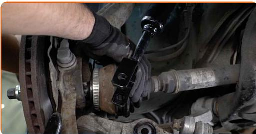
**62** Pulisci gli elementi di fissaggio del braccio di controllo. Usa una spazzola metallica. Usa lo spray WD-40.
