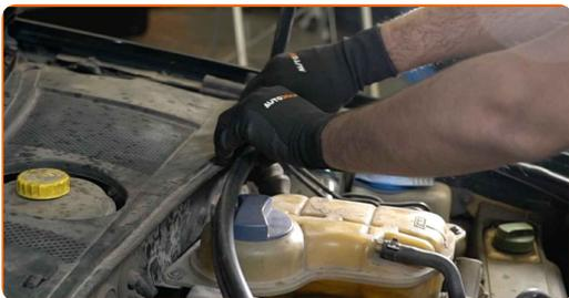
**97** Rimuovi la copertura di protezione del parafrango.
