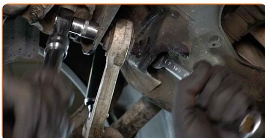
**74** Installa il puntone stabilizzatore trasversale.
