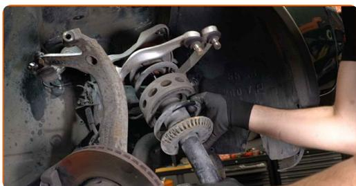
**32** Montare il supporto di ammortizzazione sul dispositivo speciale per la compressione delle molle.
