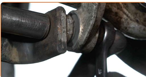
**77** Puntellare il fuso a snodo. Usa un cric idraulico per trasmissione.
