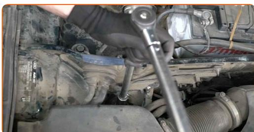
**94** Tratta con del prodotto gli elementi di fissaggio del supporto del puntone dell'ammortizzatore. Usa il grasso al rame.
