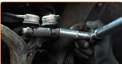
**82** Rimuovi il supporto da sotto il fuso a snodo.
