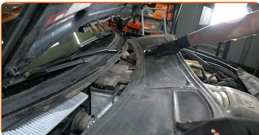
**96** Installa la guarnizione griglia sottoparabrezza.
