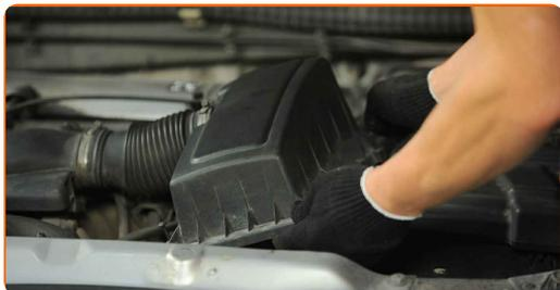
5 Rimuovere dall'alloggiamento del filtro l'elemento filtrante da sostituire.
