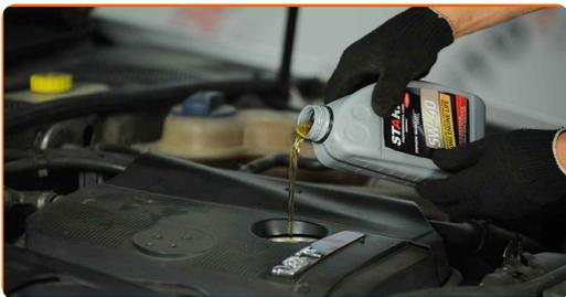
Sostituzione: olio motore e filtro - VW Passat B5 Variant. Consiglio:
