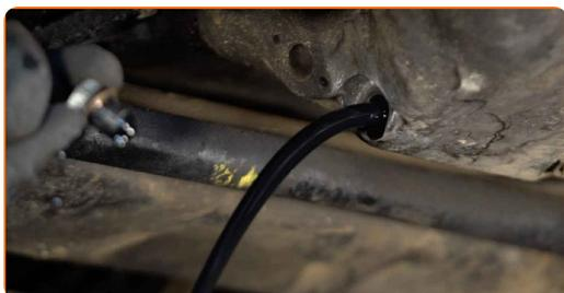
**Sostituzione: olio motore e filtro - VW Passat B5 Variant. Il consiglio di AUTODOC:**
