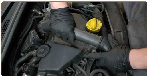
**23** Fissa il collare di fissaggio al tubo di aspirazione. Usa delle pinze universali.
