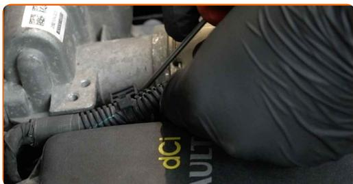
**8** Svita gli elementi di fissaggio del coperchio del motore. Utilizza una chiave a bussola N°10. Usa una chiave a cricchetto.
