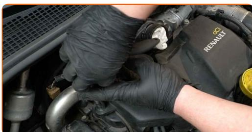
**20** Collegare il cablaggio del motore. Usa un giravite piatto.
