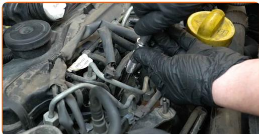
**16** Stringere le candele. Usa la chiave a bussola per candele numero 10. Usa una chiave dinamometrica. Serralo fino allo coppia di torsione di 15 Nm.
