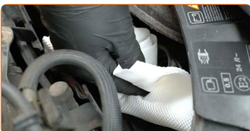
**7** Separare il cablaggio del motore. Usa un giravite piatto.
