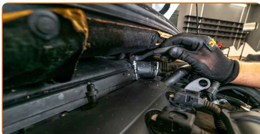
7 Scollega il tubo di aspirazione dell'aria dall'alloggiamento del filtro dell'aria.
