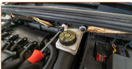
4 Rimuovi il serbatoio del fluido dei freni. Mettilo da parte.
