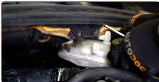
5 Svita il morsetto e gli elementi di fissaggio del tubo di aspirazione del filtro dell'aria . Utilizza una chiave combinata N°7.
