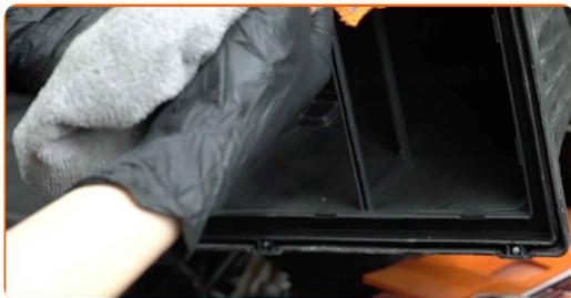
**9** Inserire un nuovo elemento filtrante nell'alloggiamento del filtro. Assicurarsi che i bordi del filtro aderiscano all'alloggiamento.
