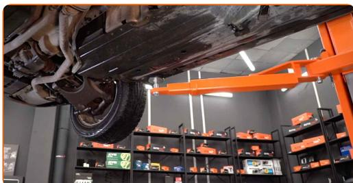
**2** Pulisci gli elementi di fissaggio dei tubi di rifornimento carburante. Usare una spazzola pulente in nylon. Usa un detergente spray multiuso.
